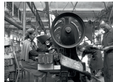
4. Sertissage sur presse verticale, 1952. CAA Crimping on a vertical press, 1952.
