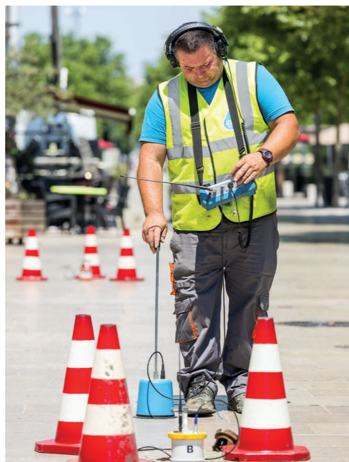
▼ Opération de recherche de fuite par écoute au sol
