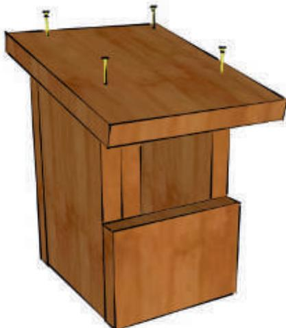
Pose du toit. Fixation avec 4 vis plus longues.
