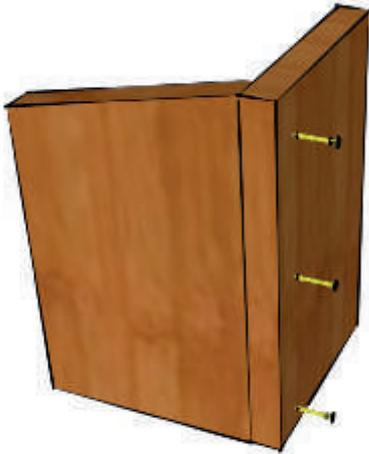
Assemblage de l'arrière et d'un côté avec 3 vis.
