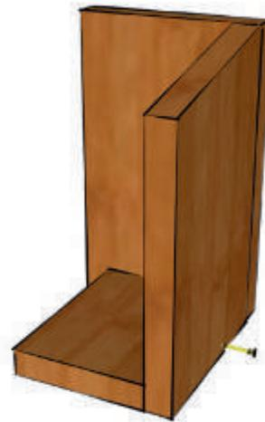
Pose du fond. Mettre une vis par côté.
