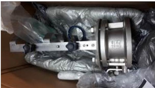
Sonde mesure de la matière en suspension
